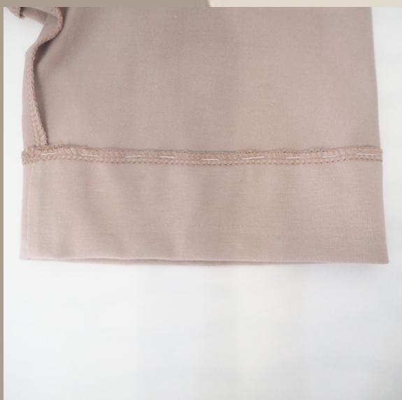
Отвернуть припуск подгибки низа рукавов на 6 см, предварительно обметав нижние срезы по кругу. Приколоть припуск и приметать вручную так, чтобы строчка проходила по центру оверлочной строчки.
