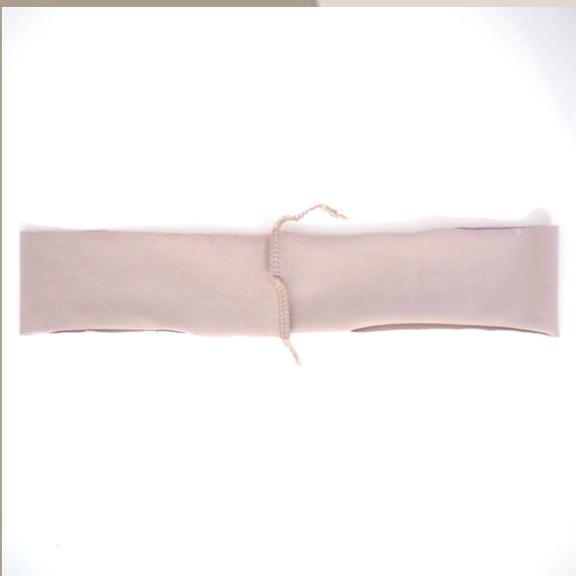
Деталь бейки горловины сложить внутрь лицевой стороной пополам, сколоть короткие срезы, стачать на оверлоке. Приутюжить шов на ребро (для уменьшения толщины шва) и заутюжить припуск до центра на одну сторону, от центра – на другую, как показано на фото.
