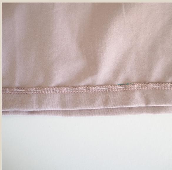
Обметать на оверлоке нижний срез футболки по кругу. С помощью иглы с тупым концом продеть концы оверлочной строчки внутрь шва оверлока с изнаночной стороны.
