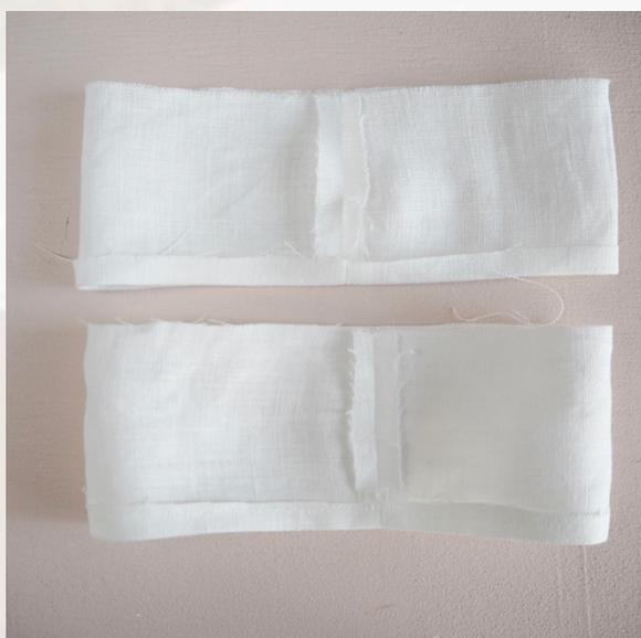
На деталях манжет стачать по коротким срезам. Припуски разутюжить. Нижний припуск заутюжить на изнаночную сторону на 1 см
