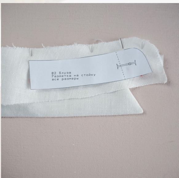
По шаблону нанести разметку на стойку (важно, чтобы округлые срезы стойки были прошиты зеркально и аккуратно)
