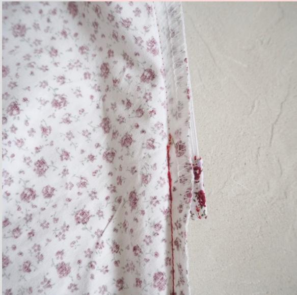
От нижней закрепки шва притачивания молнии до низа юбки проложить машинную строчку, предварительно сложив детали спинки юбки лицом к лицу. Строчка должна начинаться поверх предыдущей строчки ровно попадая в нее (удобнее использовать однорожковую лапку).
