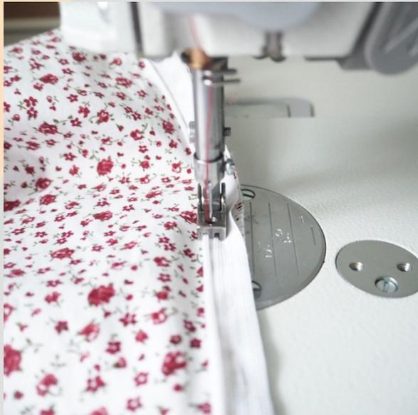
Установить на машину лапку для втачивания потайной молнии (на фото лапка для промышленной машины). Установить иглу в крайнее левое положение (в некоторых лапках этого делать не нужно). Отогнуть зубчики молнии и вставить машинную иглу максимально близко к зубчикам так, чтобы они попали в нижнее полосье лапки. Прострочить по длине молнии до контрольных меток, с закрепками в начале и конце строчки.
