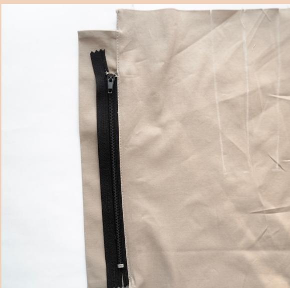
К левой стороне брюк приложить откосок с молнией, перекрыть заутюженным припуском шов притачивания на молнии. Отстрочить по сгибу припуска, захватывая молнию с откоском. Приутюжить
