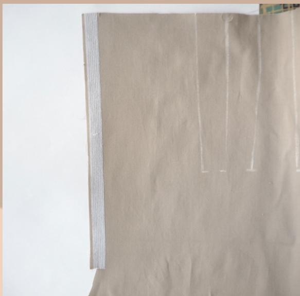
Проклеить клеевой кромкой припуск вдоль участка втачивания молнии (у левой половинки брюк). Проклеить срезы вдоль входов в карман на деталях переда и спинки. Клеевая лента клеится на расстоянии от края 2-3 мм, чтобы в последующем, шов попадал на ленту, а не шел вдоль нее (поскольку ширина припуска и ленты совпадают). На правой половинке брюк продублировать гульфик до линии сгиба. Продублировать полностью откосок.
