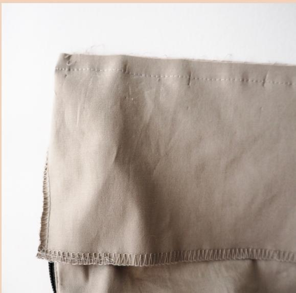
У второй стороны короткого среза обтачки завернуть припуск на 1 см на изнанку, обогнув участок притачивания молнии.
