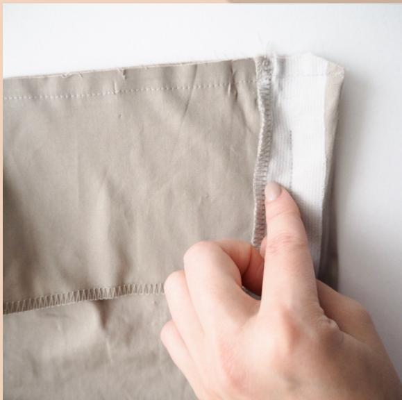
Сложить деталь обтачки лицом к лицу с верхним срезом брюк, сколоть совмещая боковые швы. В месте соединения с гульфиком короткий срез обтачки сколоть с гульфиком (стачать сначала этот короткий срез, заутюжить припуски на обтачку). Затем стачать по верхнему срезу обтачку с деталями переда и спинки брюк, начиная строчку со сгиба гульфика. Уголок высечь как показано на фото.
