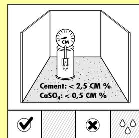
Убедитесь в том, что черный пол имеет ровную поверхность. Любые неровности, составляющие более 2 мм на 1 метр длины, должны быть выровнены. При наличии системы подогрева панелей напольного покрытия температура черного пола не должна превышать 28°C при влагосодержании не более 1,5% (при расчете по методу CM) или не более 2 фн./24 ч. (при расчете по методу хлорида кальция ASTM 1869). В этом случае необходимо пользоваться специальными указаниями по укладке.
