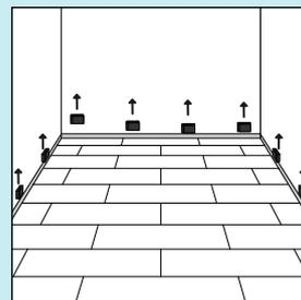
28 Установите плинтус поверх подложки/пленки, выходящей на стену из-под пола. Ни в коем случае не прикрепляйте плинтус к полу. Указанный способ позволяет напольному покрытию расширяться и сжиматься под плинтусом. В тех местах, где невозможно разместить профили или плинтусы, заполните температурные швы пластичным герметиком
